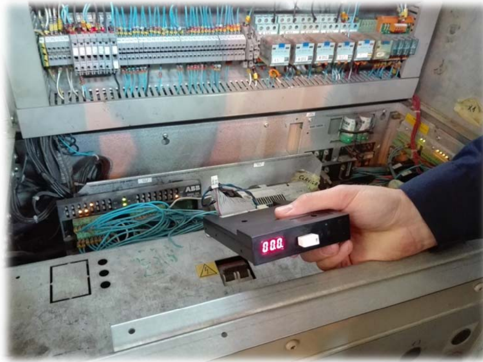
شکل ۶ : نحوه اتصال صحیح ماژول مبدل USB به فلاپی داخل کنترلر ربات
